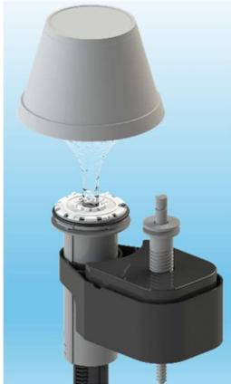
**9.3** Colocar una taza de café invertida sobre el cabezal de la Válvula, abrir el suministro de agua con una mano, mientras que sostiene con la otra mano la taza invertida. Dejar correr el agua durante 1 minuto para que purgue cualquier basura que pudiera haber en la cañería.
