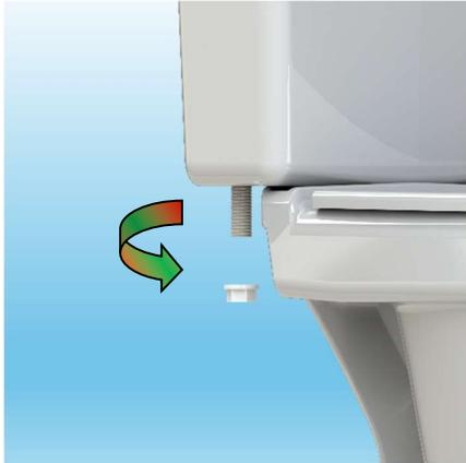
**2.2** Desenrosque la tuerca de la válvula vieja colocando un recipiente debajo para recolectar el remanente de agua que pudiera quedar en el depósito. Una vez liberada la Tuerca, proceda a retirar la Válvula vieja.
