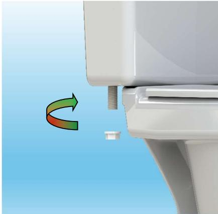
**4.1** Ajuste la tuerca con la mano hasta que haga tope, luego aplicar  $\frac{1}{4}$  de vuelta más para mayor seguridad mediante una llave fija, pico de loro o francesa. No excederse con el ajuste.
