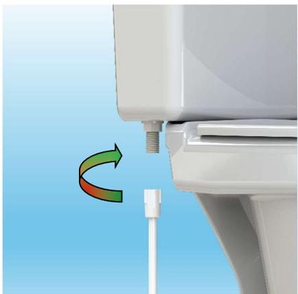
**4.2** Conecte el flexible de suministro de agua, girando la tuerca hacia la derecha en sentido horario.
