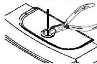
Enroscar el cuerpo del botón en el buje de la descarga, fijando la tapa, como indica la figura
