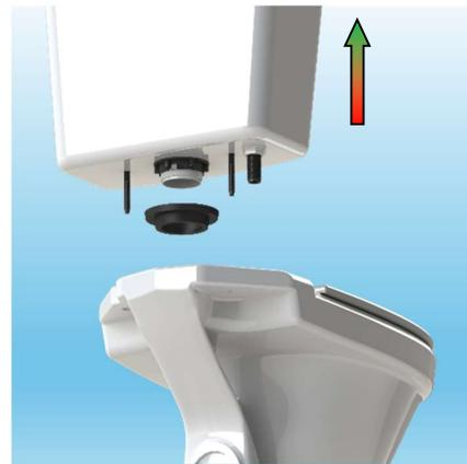
Desmonte el depósito y retire las válvulas viejas.
