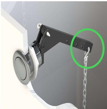
**3.3** Por último conecte el gancho de la cadena al orificio del Balancín que mantenga la cadena casi tensa, con un poco de flexión. Corte el excedente del Balancín de ser necesario.
