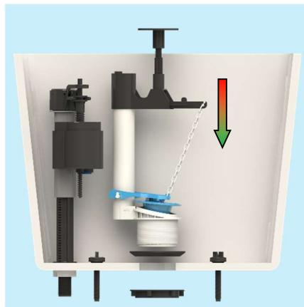
**3.2** Colocar la Válvula de Descarga en el interior del depósito y ajustar la tuerca con la mano desde el exterior. No excederse con el ajuste. De ser necesario girar  $\frac{1}{4}$  de vuelta más para asegurar el ajuste.
