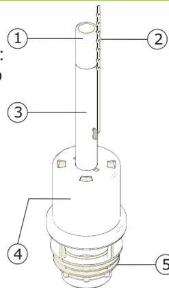
Desenroscar la tuerca inferior de la descarga procurando que la junta quede en válvula.
