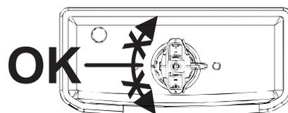
Enroscar la tuerca de fijación verificando que la descarga quede en la posición indicada.
