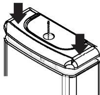
Enroscar el cuerpo del botón en el buje de la descarga, fijando la tapa, como indica la figura
