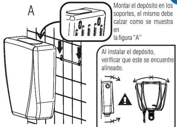
Montar el depósito en los soportes, el mismo debe calzar como se muestra en la figura "A"
