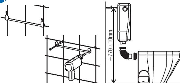
Coloque el soporte nivelado y centrado al eje del inodoro (aproximadamente 770mm del nivel del piso). Marque los puntos de anclaje para realizar las perforaciones para 2 tarugos plásticos de  $\varnothing 8\text{mm}$ . Una vez colocados amurar el soporte.
