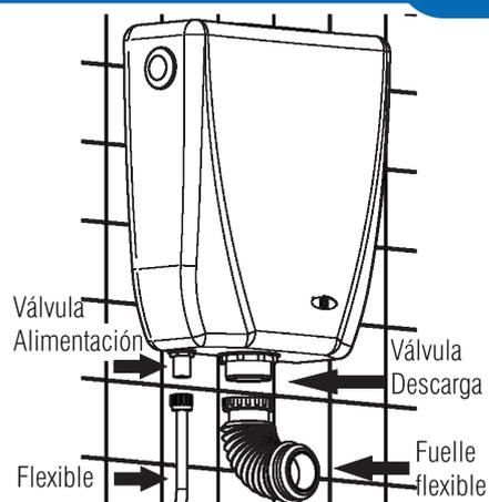
Conectar el fuelle a la descarga y el flexible a la válvula de alimentación.
