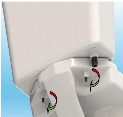
**7.1.3** Coloque el depósito sobre el inodoro, a través de los orificios del sanitario y ajuste las tuercas en sentido anti horario, contra la base del inodoro.
