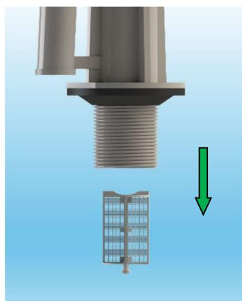
**11.4.1** Desarme la Válvula de Admisión y retire el filtro de agua tal como se observa en la imagen. Limpiarlo como se indica más adelante o cámbielo por uno nuevo.
