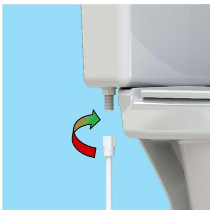
**2.1** Desconecte el flexible de suministro de agua, girando la tuerca hacia la izquierda en sentido anti horario.
