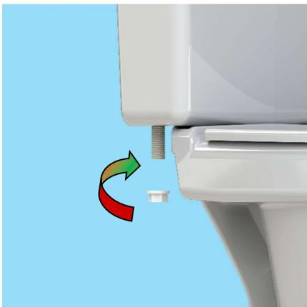
**2.3** Desenrosque la tuerca de la válvula vieja colocando un recipiente debajo para recolectar el remanente de agua que pudiera quedar en el depósito. Una vez liberada la Tuerca, proceda a retirar la Válvula vieja.
