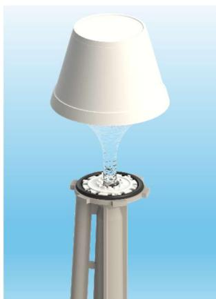
**18.3** Colocar una taza de café invertida sobre el cabezal de la Válvula, abrir el suministro de agua con una mano, mientras que sostiene con la otra mano la taza invertida. Dejar correr el agua durante 1 minuto para que purgue cualquier basura que pudiera haber en la cañería.
