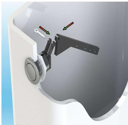
**8.2** Tomar el Balancín y colocarlo entremedio de las patas del Cuerpo de Botón (4). Una vez alineados colocar la traba como se observa en la figura.
