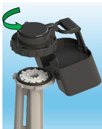
**18.2 Retire la traba de la Tapa. Gire levemente a la izquierda en sentido antihorario y retire la Tapa de la Válvula.**
