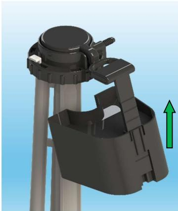
**5.4** Si el nivel de agua no es suficiente para eliminar los desperdicios, se debe corregir la regulación del flotante hacia arriba de manera que quede a 1cm por debajo de la altura de rebalse. Para garantizar que el volumen descargado elimine completamente los desperdicios.
