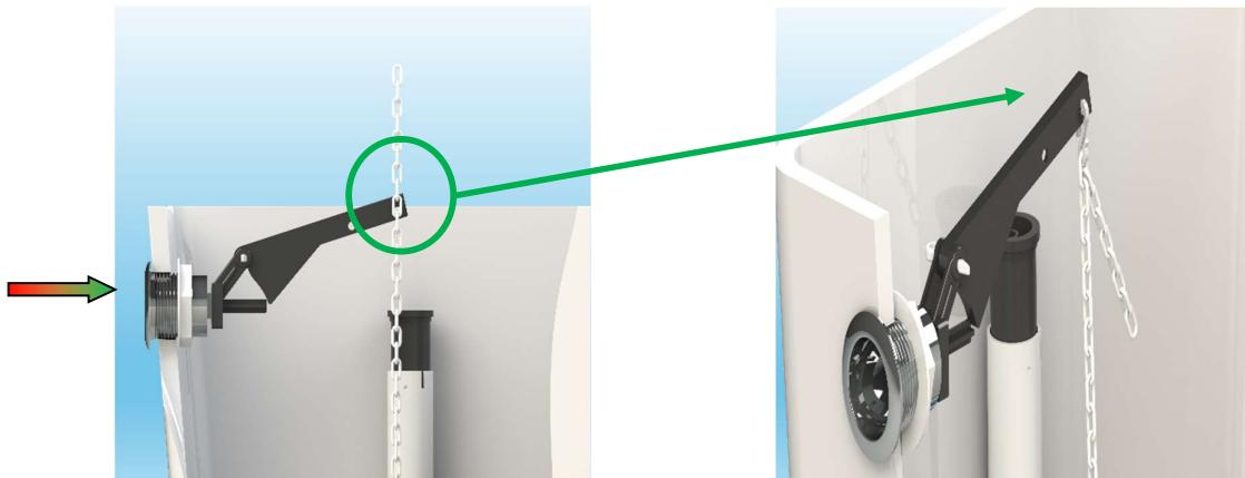
**8.4** Levante la Cadena totalmente y en el eslabón que coincide con el orificio del Balancín, deberá colocar el Gancho.
