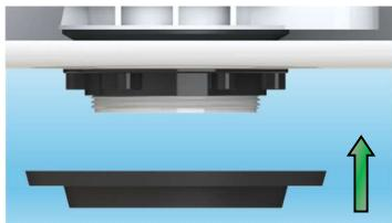
**7.1.1** Colocar la junta de goma sobre la descarga del lado externo, presionándola bien contra la cerámica del depósito.
