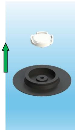
**18.4** Levante el Diafragma y limpiarlo con abundante agua jabonosa y un cepillo de dientes gastado. Luego vuelva a colocarlo junto con la Tapa de manera inversa a como se retiró, en el Cuerpo de la Válvula de Admisión.
