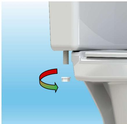
**6.1** Ajuste la tuerca con la mano hasta que haga tope, luego aplicar  $\frac{1}{4}$  de vuelta más para mayor seguridad mediante una llave fija, pico de loro o francesa. No excederse con el ajuste.
